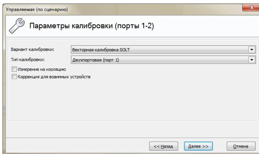
Рисунок 3.19 – Выбор двухпортовой калибровки в одном направлении
