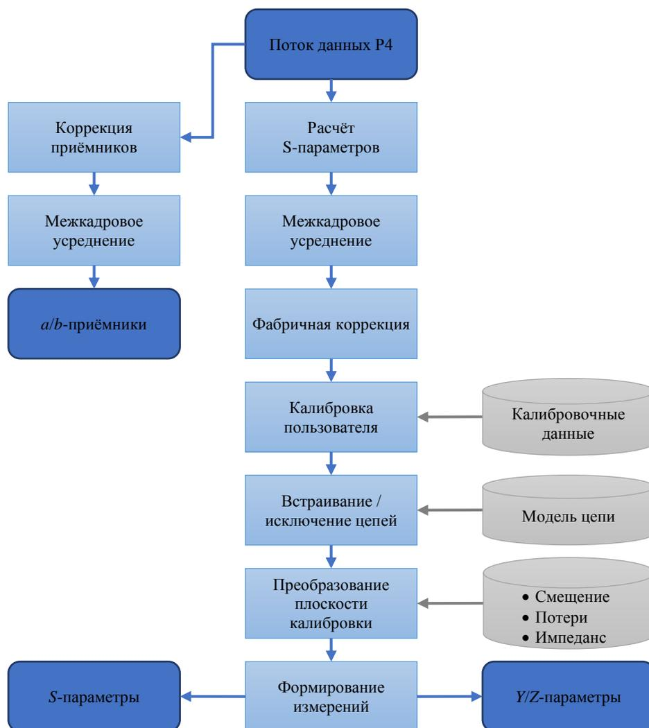
Рисунок 2.8 – Блок-схема обработки данных в измерительном канале
