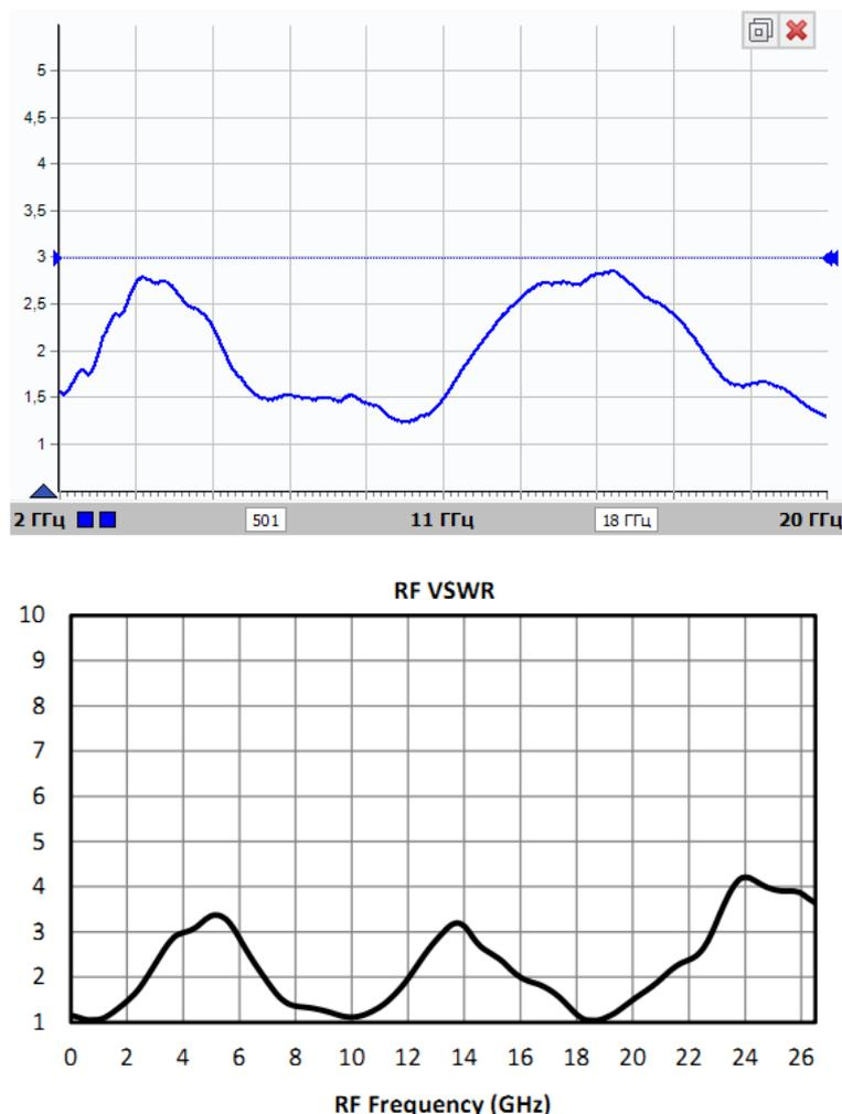
Рисунок 5.40 – Результат измерения  $S_{11}$  (синяя) и паспортная<sup>1)</sup> характеристика смесителя (чёрная) в формате КСВН
