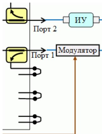
Рисунок 5.48 – Схема с модуляцией зондирующего сигнала
