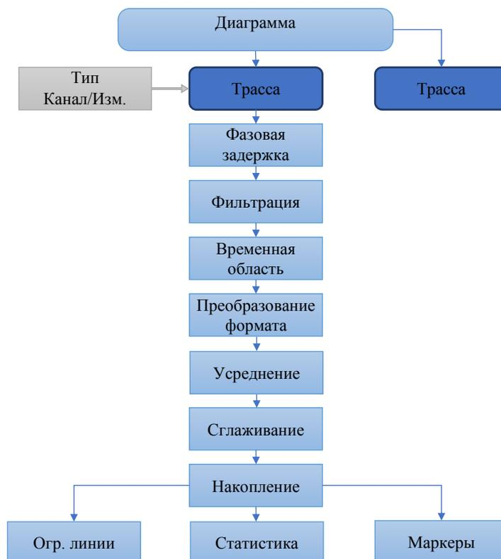
Рисунок 2.23 – Блок-схема обработки данных в трассе
