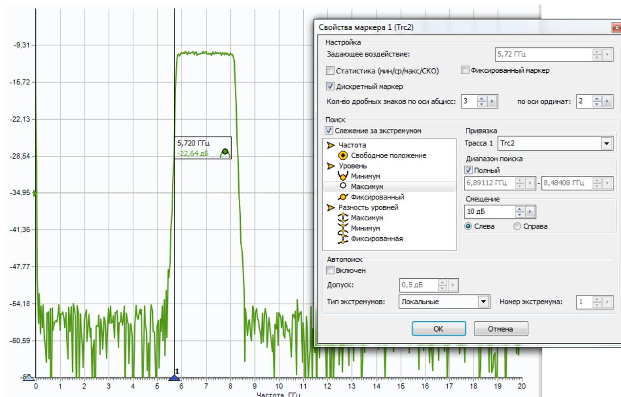
Рисунок 2.46 – Демонстрация особенностей работы маркера при поиске экстремума
