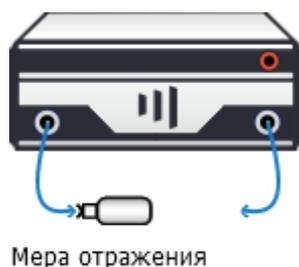
Рисунок 3.15 – Калибровка на ХХ и КЗ
