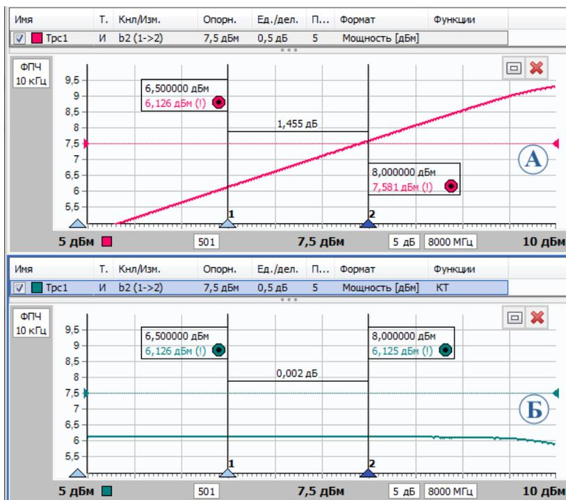
Рисунок 2.50 – Функция компенсации тренда в связанном маркере
