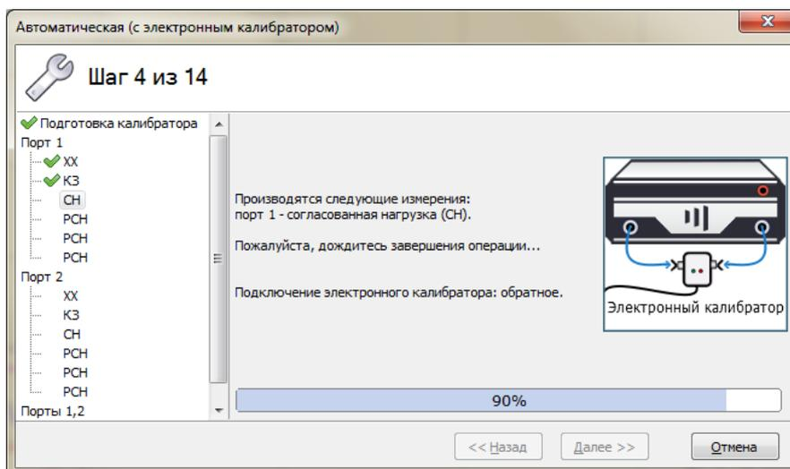
Рисунок 3.25 – Процесс калибровки с использованием ЭК
