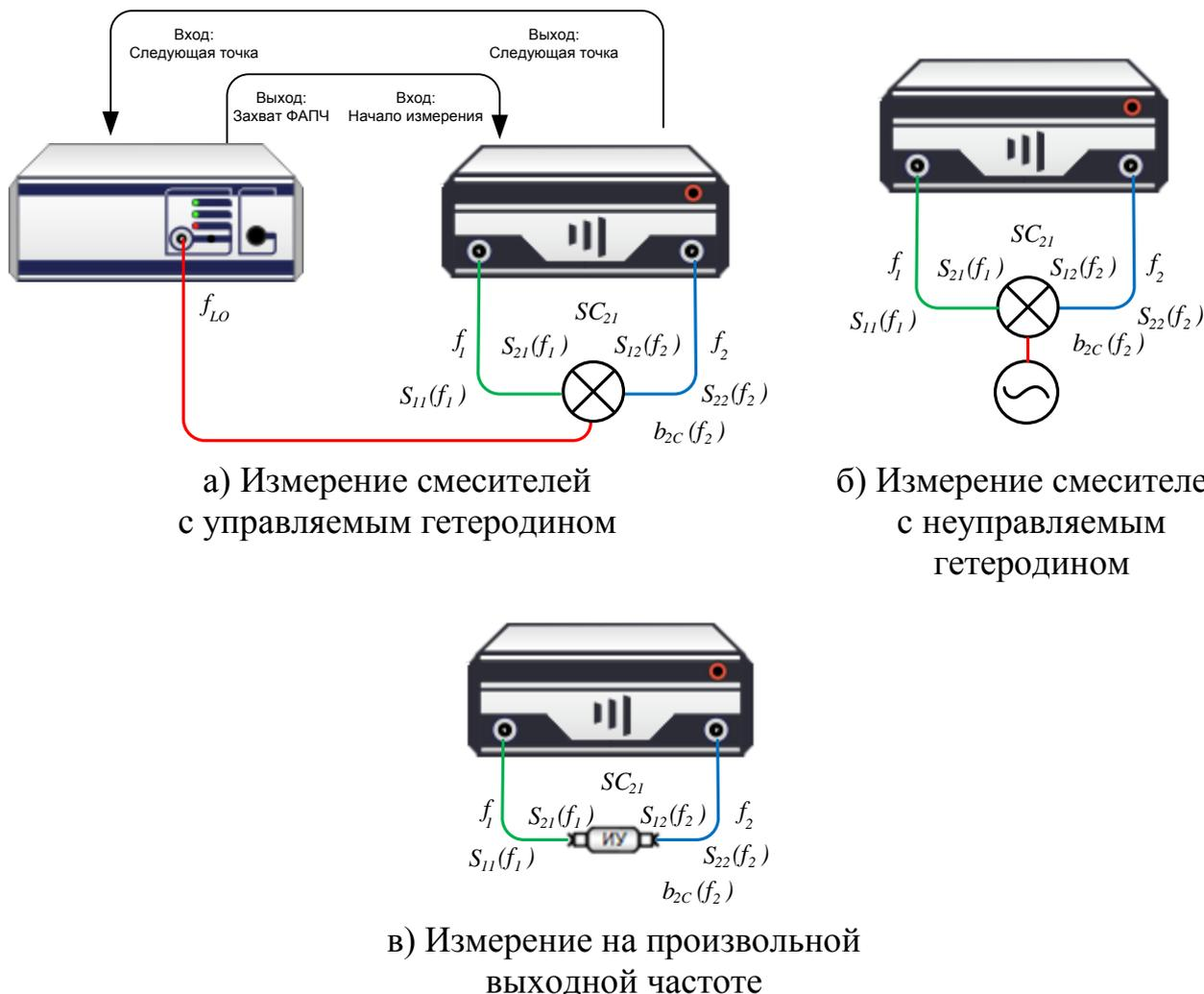
Рисунок 5.43 – Измерение с преобразованием частоты со скалярной калибровкой
