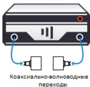
Рисунок 3.26 – Измерения в волноводном тракте
