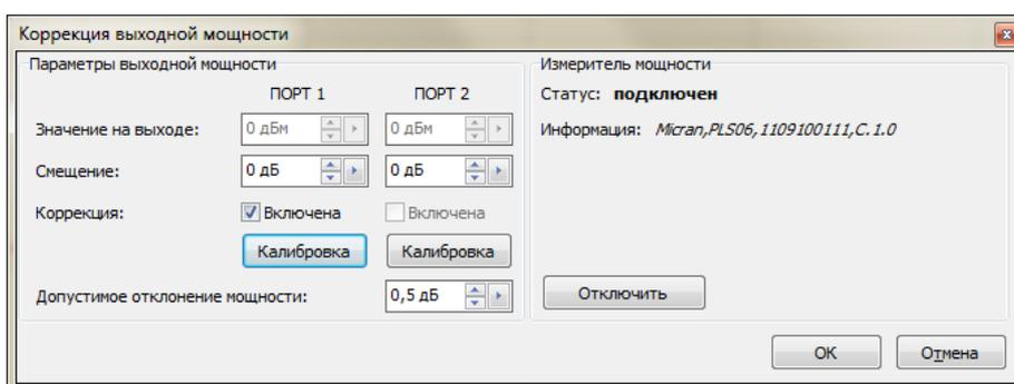
Рисунок 3.35 – Окно «Коррекция выходной мощности» после успешной калибровки
