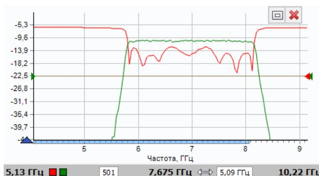
Рисунок 2.27 – Смещение диапазона сканирования
