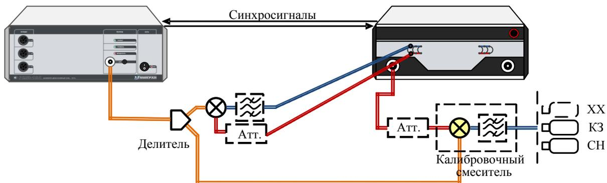
Рисунок 5.35 – Схема измерения параметров отражения «калибровочного» смесителя (шаги 7-9)
