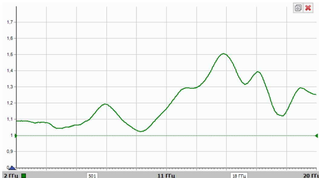
Рисунок 5.41 – Результат измерения  $S_{22}$  в формате КСВН
