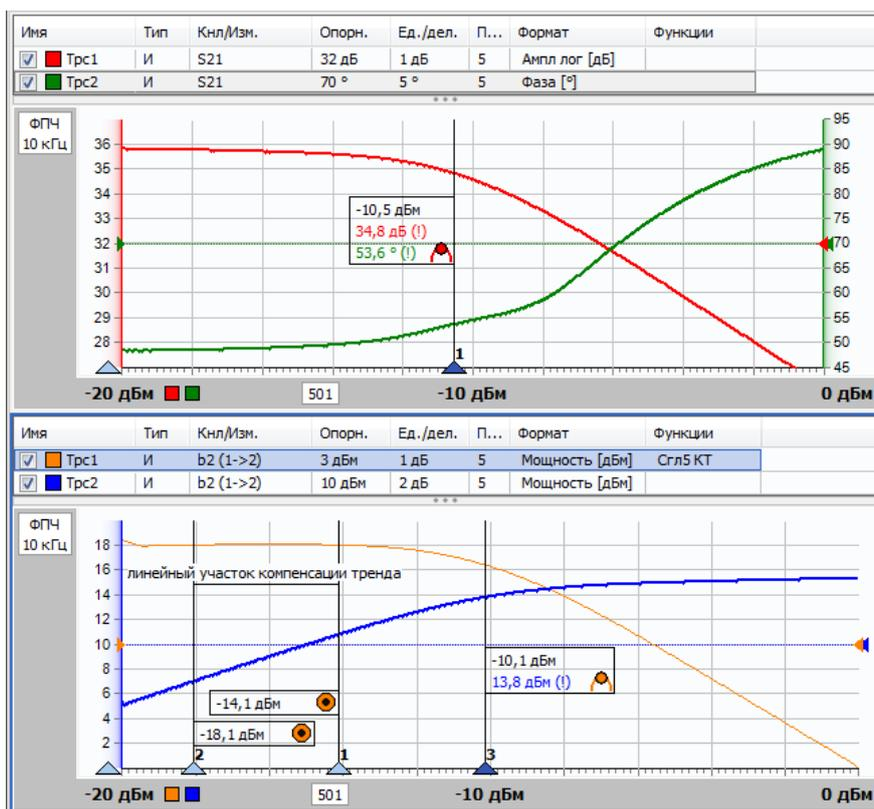
Рисунок 5.10 – Измерение параметров компрессии по коэффициенту усиления (верхняя диаграмма) и динамической характеристике (нижняя диаграмма)
