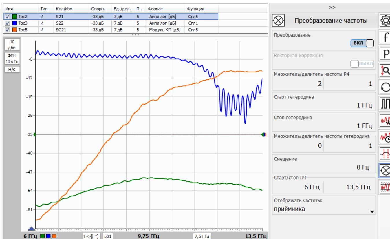
Рисунок 5.46 – Измерение умножителя частоты на два
