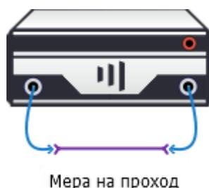
Рисунок 3.13 – Калибровка на проход
