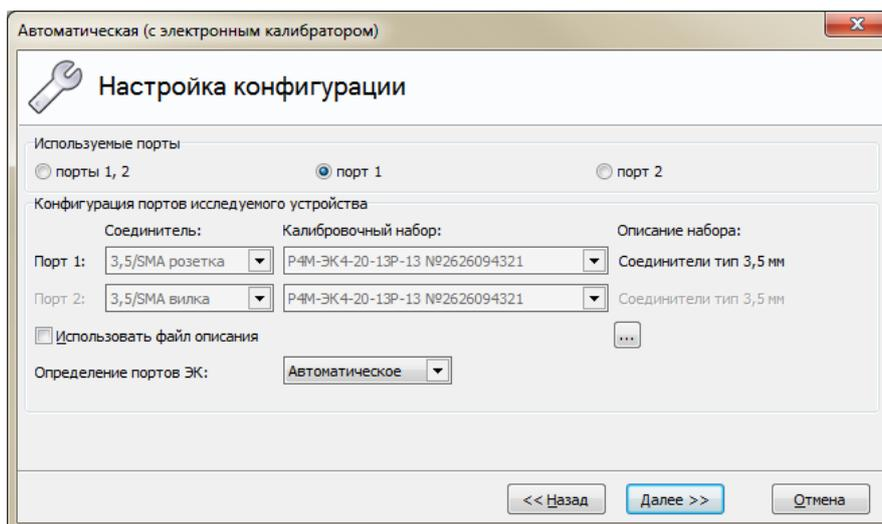
Рисунок 3.24 – Конфигурация калибровки с использованием электронного калибратора
