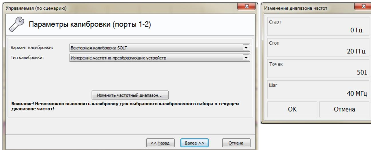
Рисунок 3.9 – Ситуация с необходимостью изменения частотного диапазона
