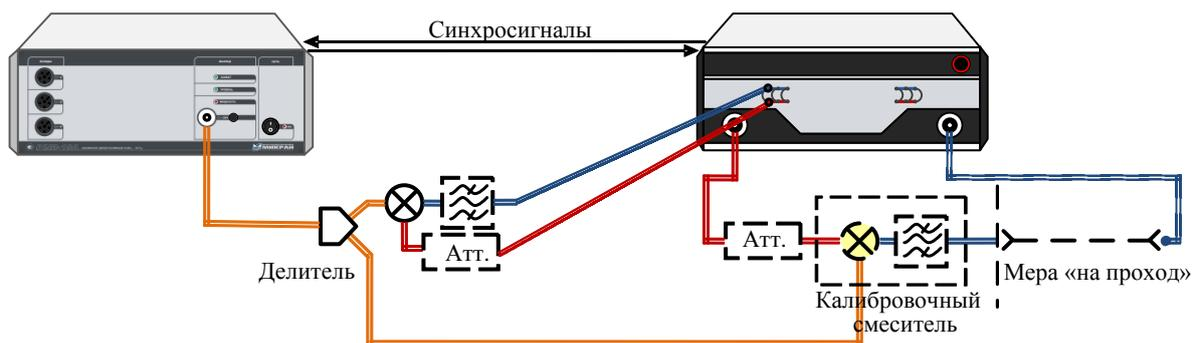
Рисунок 5.36 – Схема измерения параметров передачи «калибровочного» смесителя (шаг 10)
