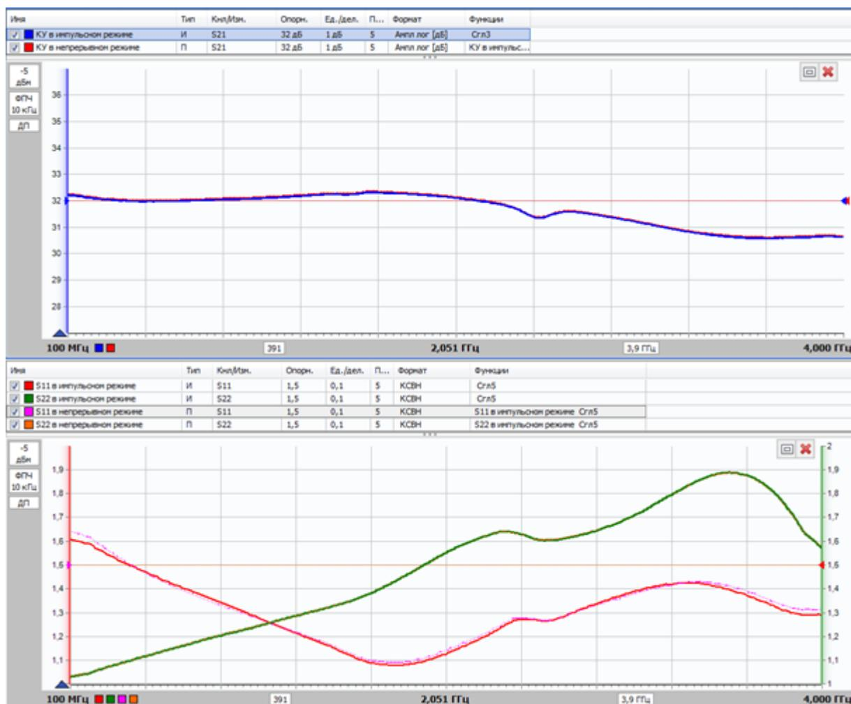
Рисунок 5.54 – Результаты измерений в «непрерывном» и «импульсном» режимах
