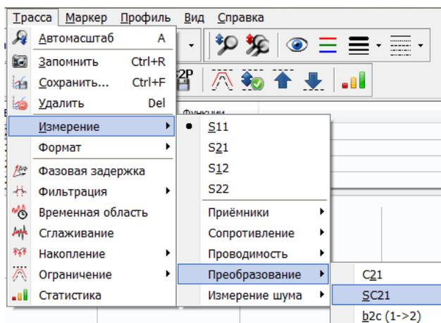
Рисунок 5.45 – Выбор «измерения»  $S_{C21}$  для трассы
