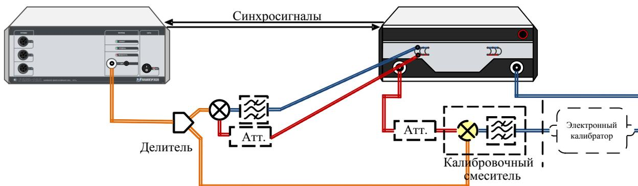
Рисунок 5.37 – Схема измерения «калибровочного» смесителя с электронным калибратором (шаги 7-10)
