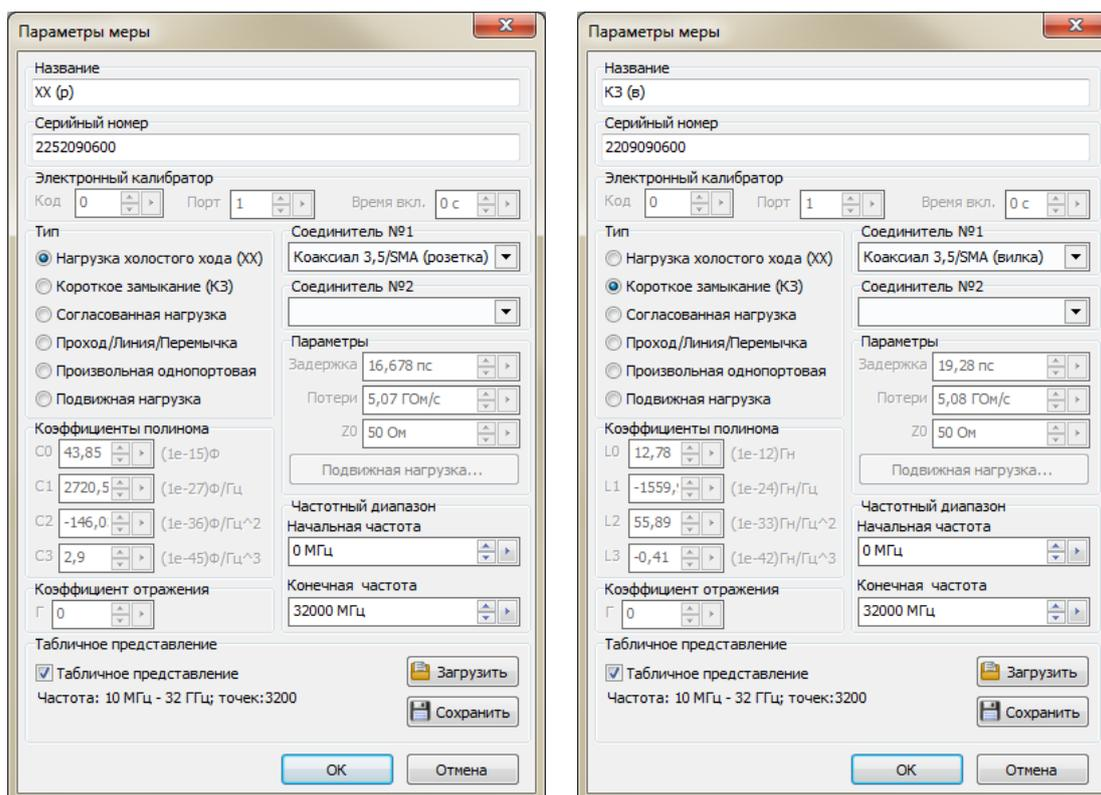
Рисунок Б.4 – Параметры нагрузок ХХ и КЗ
