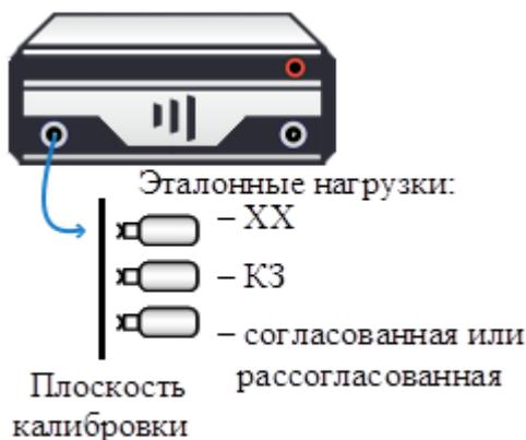
Рисунок 3.18 – Однопортовая калибровка
