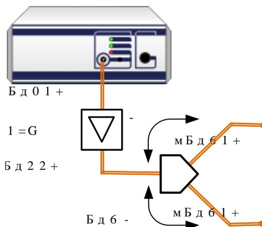
Рисунок 5.38 – Схема формирования сигнала гетеродина
