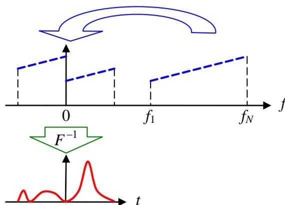
Рисунок 5.14 – Преобразование *BandPass*
