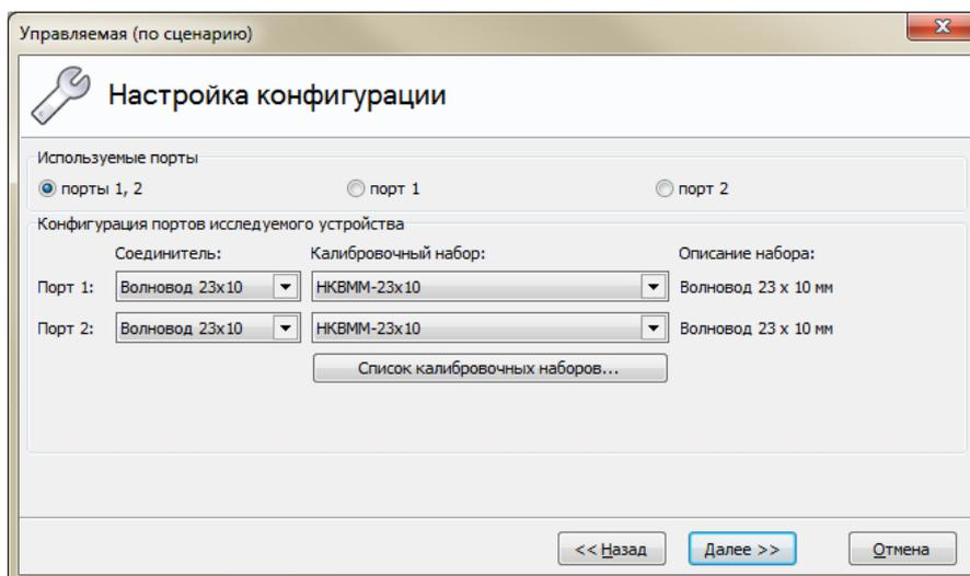
Рисунок 3.27 – Конфигурация калибровки для *TRL* калибровки
