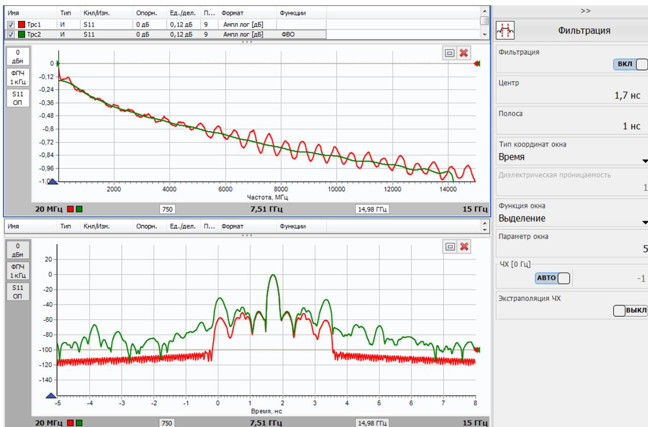
Рисунок 5.19 – Выделение полезного и подавление мешающих откликов
