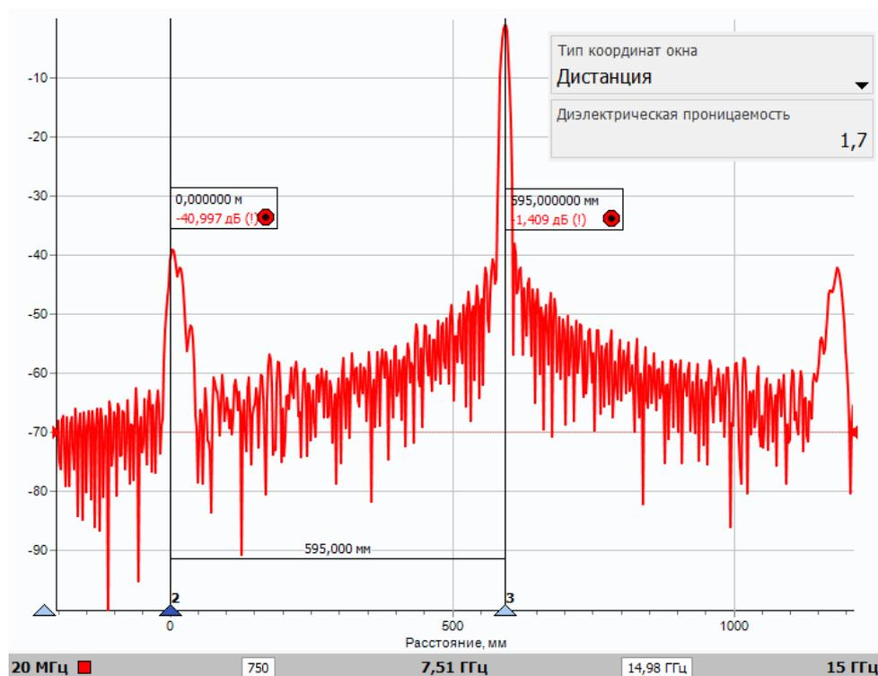
Рисунок 5.17 – Пример измерения расстояния до обрыва
