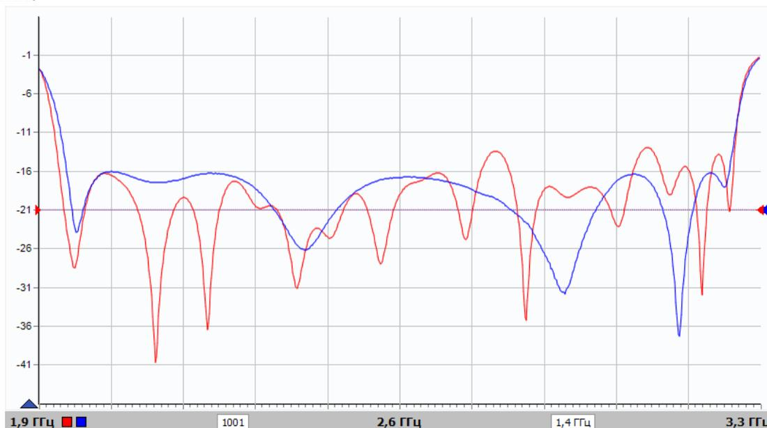
Рисунок 3.21 – Результат компенсации отражения от полосового фильтра
