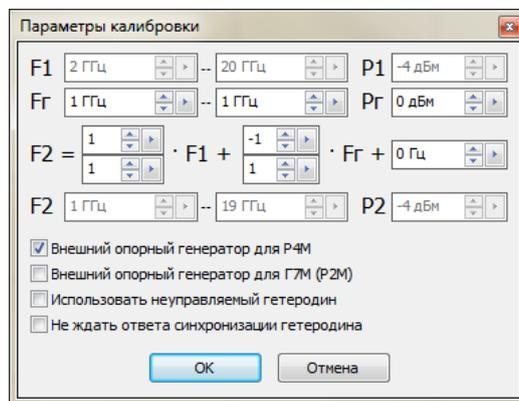
Рисунок 5.31 – Параметры калибровки с преобразованием частоты
