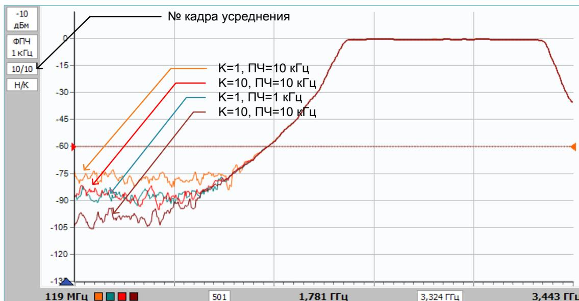
Рисунок 5.2 – Влияние усреднения и полосы пропускания фильтра ПЧ
