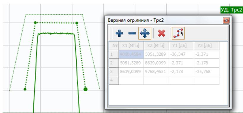
Рисунок 2.33 – Режим графического редактирования ограничительной линии
