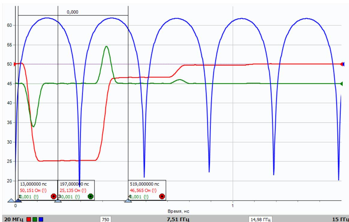
Рисунок 5.16 – Импульсная и переходная характеристики стандарта *Beatty*
