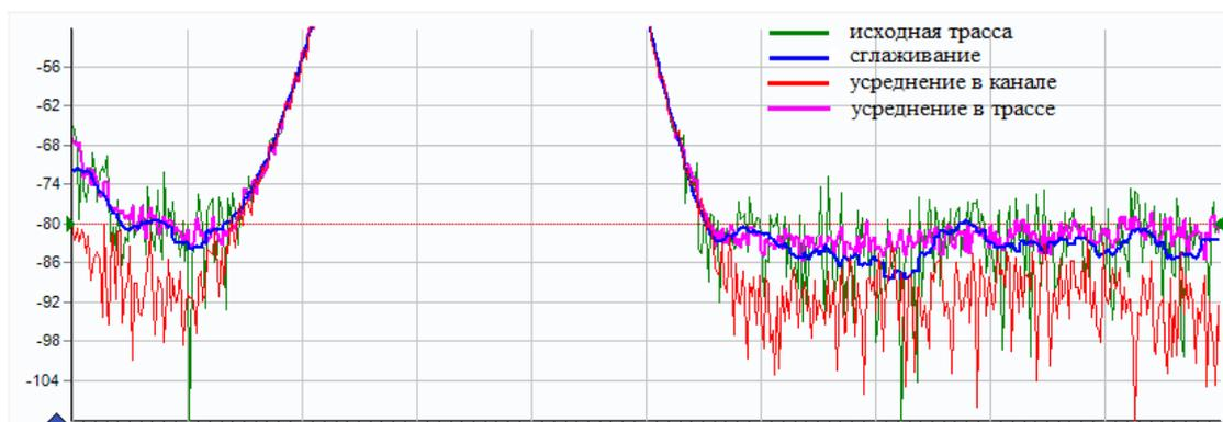
Рисунок 2.29 – Сглаживание и усреднение трасс
