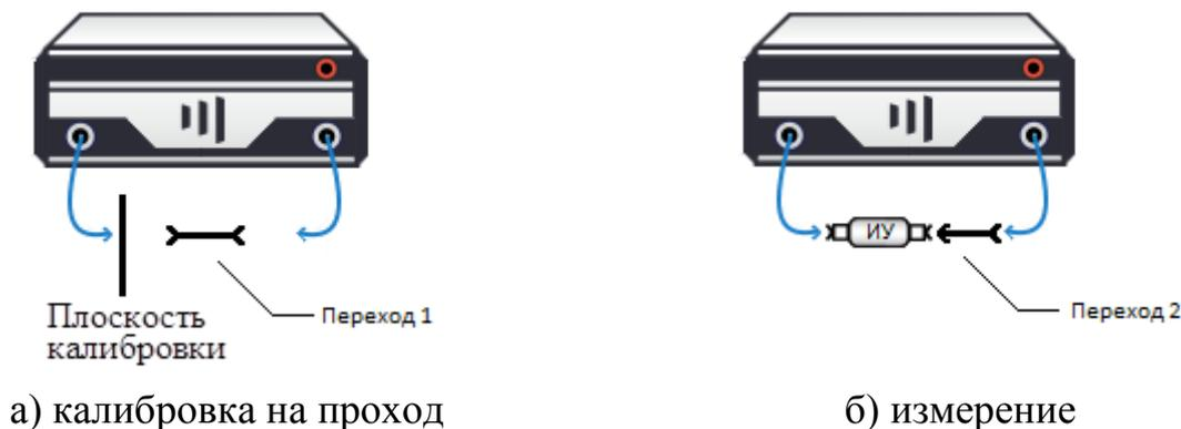
Рисунок 5.25 – Использование эквивалентных переходов
