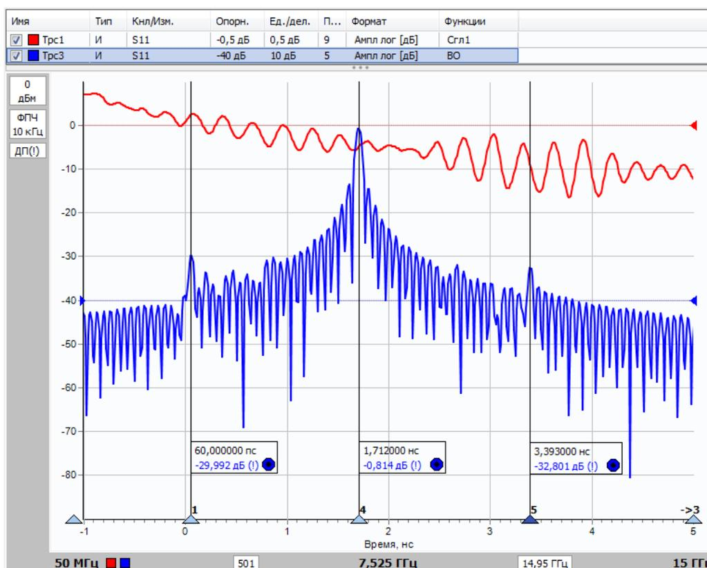
Рисунок 5.12 – Пример преобразования во временную область
